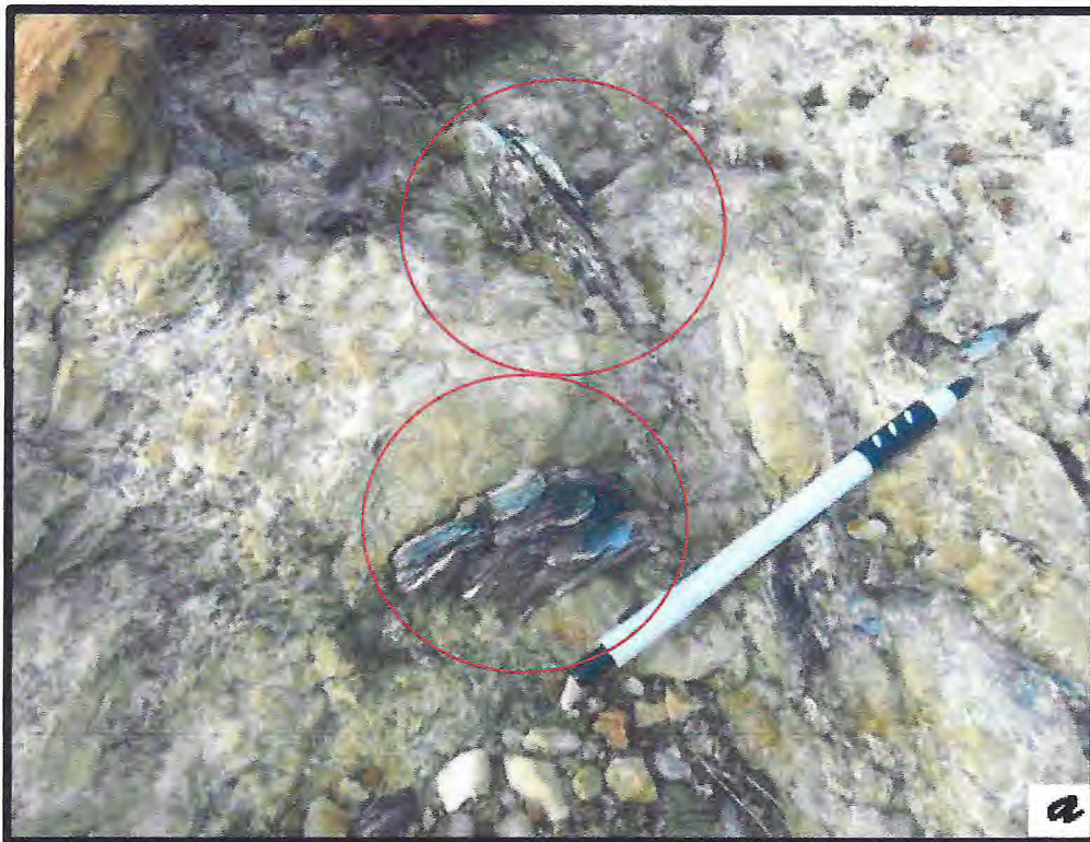
Figura 4.5: a) Pegmatito apresentando quantidade significativa de muscovita, possuindo enclaves de gnaisse. Coordenadas UTM: 0497555m E / 9417245m N. b) Grãos de granadas em uma porção granítica no pegmatito. Coordenadas UTM:
