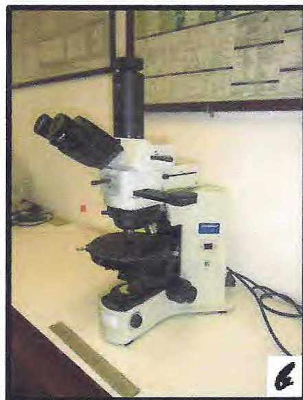
Figura 1.2: a) GPS Garmim Etrex a esquerda e Bussola Bruton a direita, da foto. b) Microscópio petrográfico Olympus BX 41.
