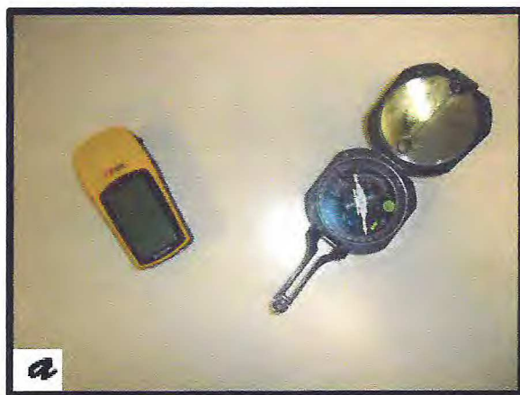
Figura 1.2: a) GPS Garmim Etrex a esquerda e Bussola Bruton a direita, da foto. b) Microscópio petrográfico Olympus BX 41.
