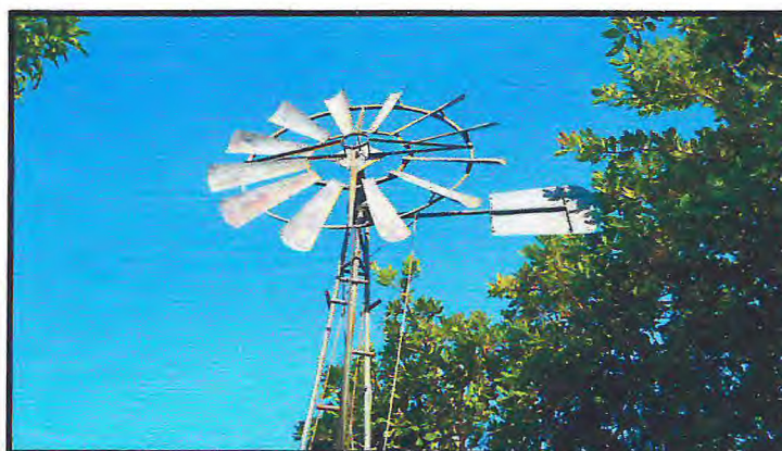
Foto 24. Cata-vento que realiza a função de bomba no P15 Coordenadas 596361 / 9539534 na comunidade do Sítio Lucas Beberibe CE (junho 2012).
