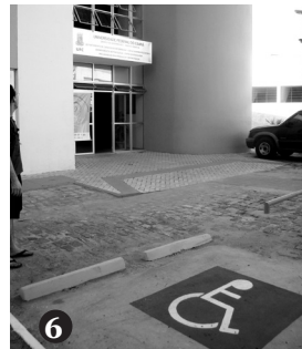
Foto 5 – Auditório Valnir Chagas – Faced/UFC. Rampa com inclinação adequada e corrimão próximo ao exigido pela NBR-9050 Foto 6 – Entrada do curso de Psicologia/UFC com rampas de acesso adequadas e vaga reservada
