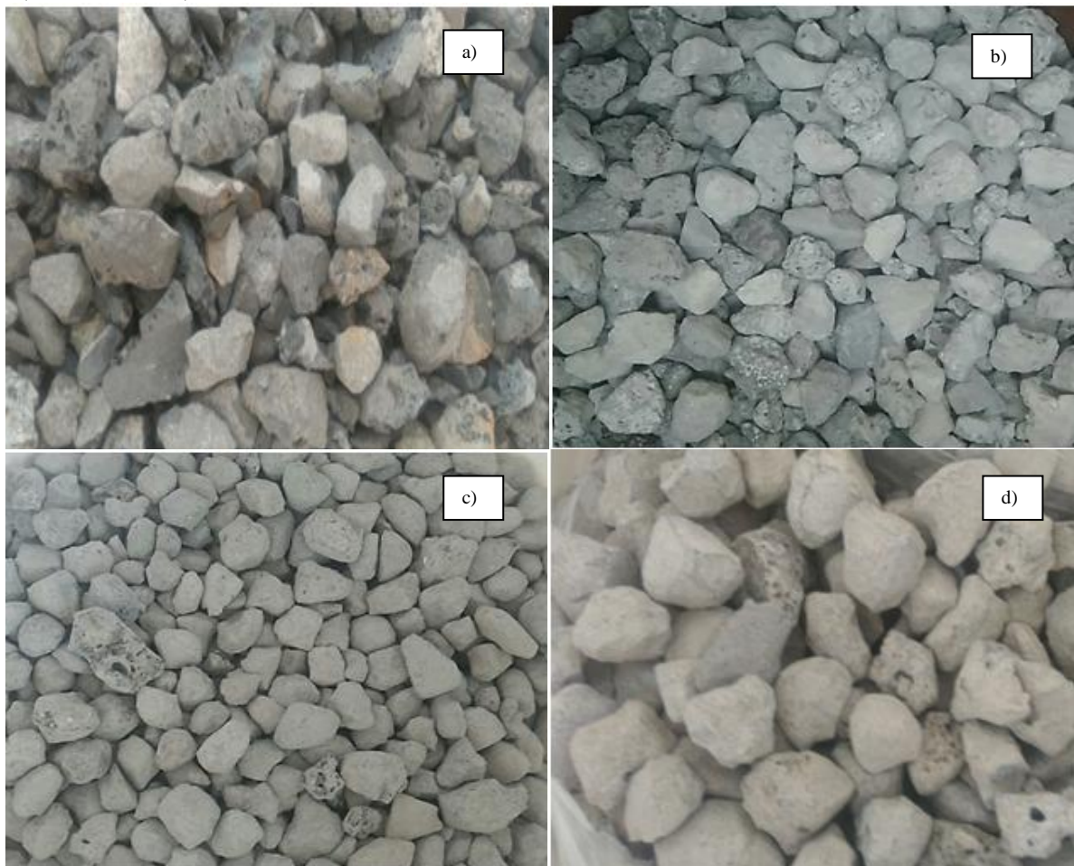
Figura 9 – Amostras de escória de aciaria intituladas como: a) BOF; b) DRY PIT; c) KR; d) PANELA; e) BSSF.
