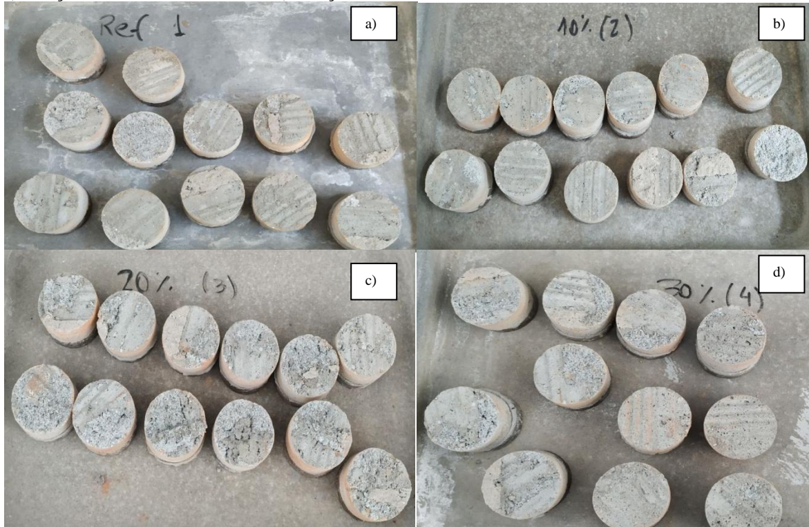
Figura 20 – Formas de ruptura obtidas no ensaio de resistência de aderência à tração para um sistema de revestimento com chapisco. a) Traço de referência; b) Traço com 10% de escória; c) Traço com 20% de escória; d) Traço com 30% de escória.
