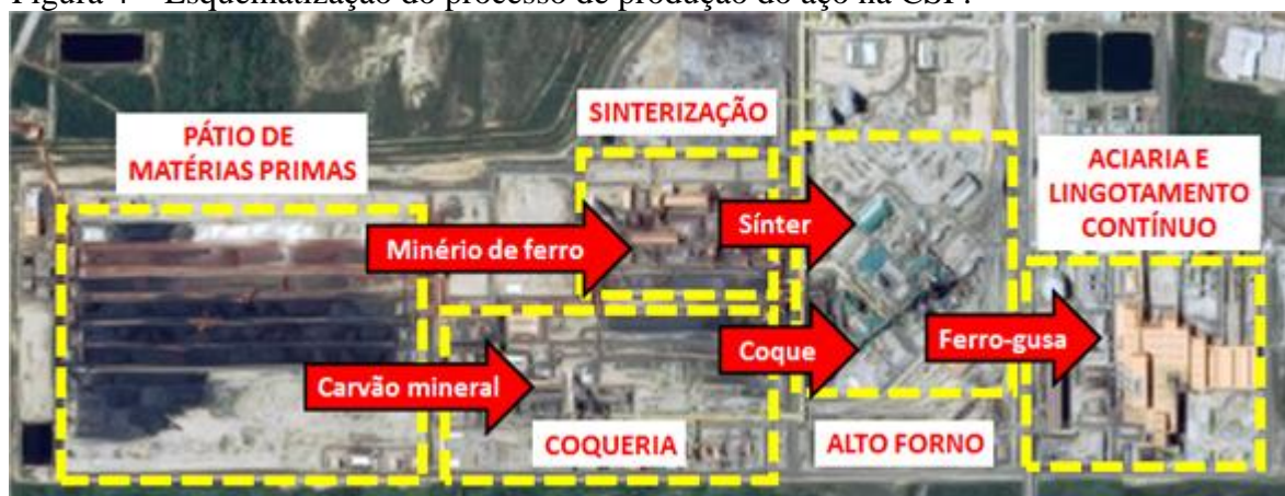
Figura 4 – Esquematização do processo de produção do aço na CSP.
