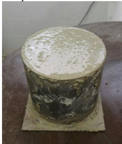
Figura 11 – Material para determinação da densidade de massa e do teor de ar incorporado.
