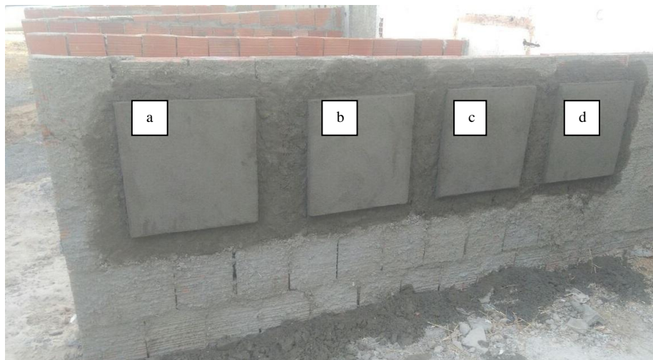
Figura 13 – Painéis executados para o ensaio de resistência de aderência à tração: a) Traço de referência; b) Traço com 10% de escória; c) Traço com 20% de escória; d) Traço com 30% de escória.
