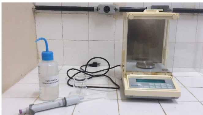
FIGURA 34: À ESQUERDA TEMOS: A BALANÇA ANALÍTICA, O MICROPIPETADOR, UM BÉQUER E A ÁGUA DESTILADA. À DIREITA TEMOS A SOLUÇÃO DE ISOLEUCINA SENDO AGITADA.
