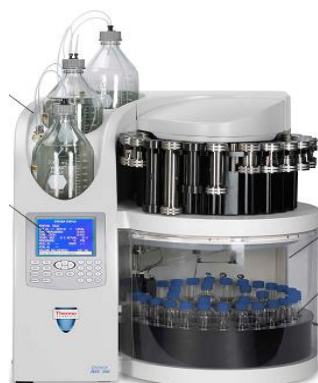
Figura 6 - ASE 350 ( Accelerated Solvent Extractor ) utilizado para extração líquida pressurizada.
