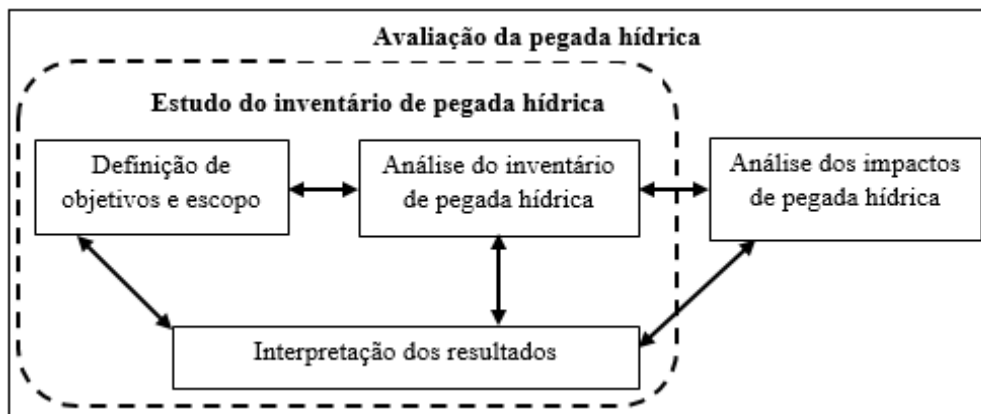
Figura 3 – Etapas de um estudo de pegada hídrica de acordo com a norma ISO 14046
