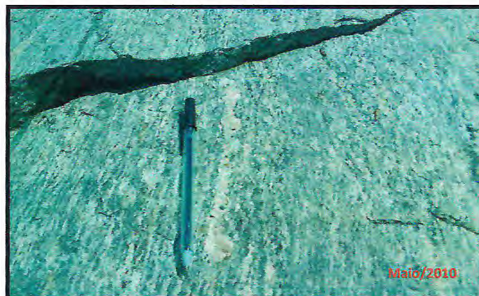
Figura-3.5 – Rocha fanerítica com textura hipidiomórfica inequigranular e granulação variando de fino a média. (Afloramento RGF-31 UTM 0459421 / 9599779)
