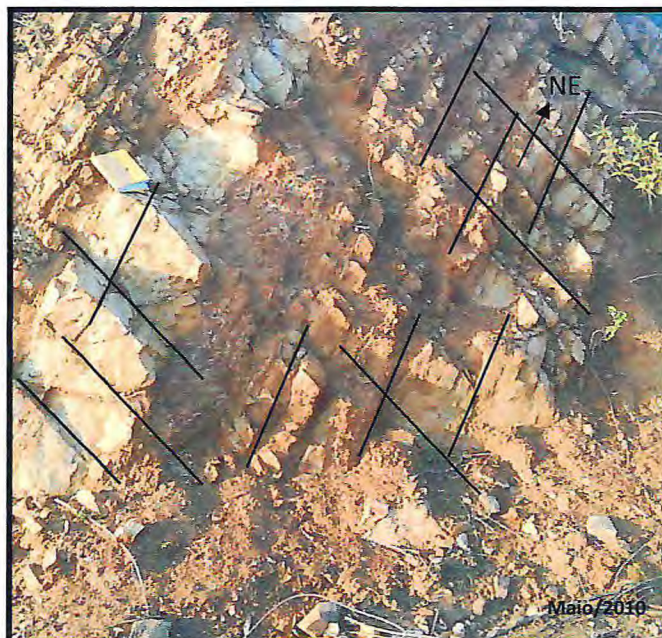
Figura-5.6: Quartzitos fraturado por duas famílias de fraturas principais e foliação de transposição S_n representa o trend regional NE. (Afloramento RGF-47 UTM 0462602 / 9597854)
