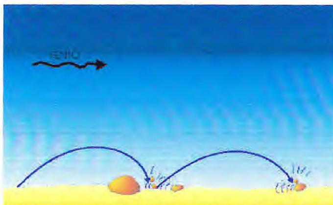
FIGURA 4.3 – Deslocamento de partículas por saltação e por arrasto (Extraído de Sígolo, 2000).
