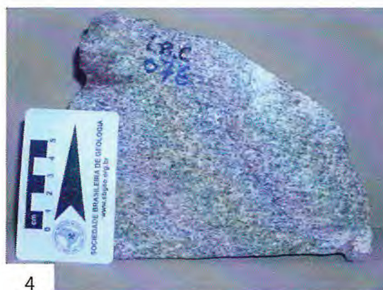
Foto 3: Granodiorito milonitizado exibindo sigmóides destrais. Foto 4: Amostra de mão do clinopiroxênio tonalito com titanita exibindo uma foliação incipiente.
