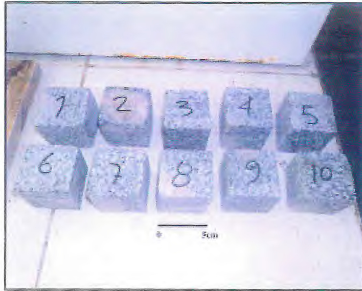
Figura 2.3 – Corpos-de-prova serrados com dimensões de 5x5x5 cm, utilizados na determinação dos Índices Físicos.
