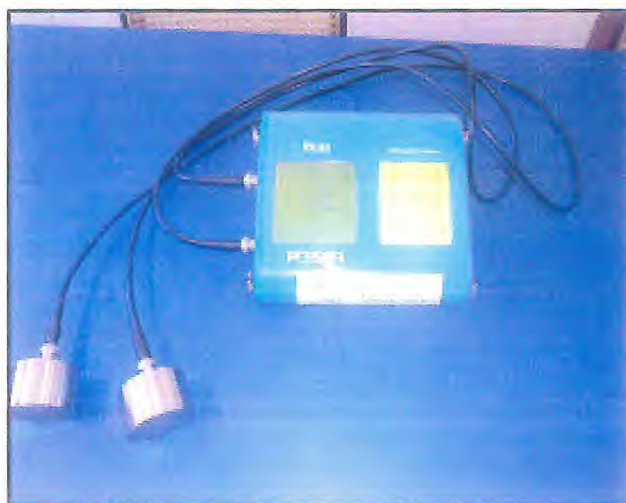
Figura 2.6 – Aparelho para medição de pulso ultrassônico TICO da DIMAT - NUTEC.
