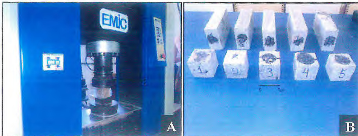
Figura 2.4 – (A) Prensa Hidráulica da DIMAT – NUTEC; (B) Corpos-de-prova com dimensões de 7x7x7 cm serrados para realização do ensaio de compressão uniaxial.
