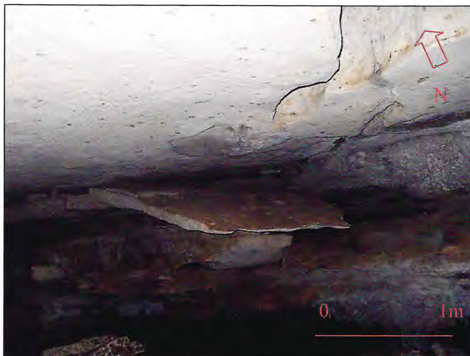
FIGURA 8.19 - Elevada porosidade da rocha permitindo a ação rápida da água, causando abatimento do teto no plano de estratificação.
