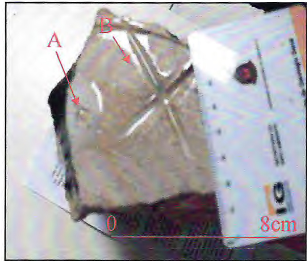
FIGURA 5.8 - Amostra 1: A. Reação do ácido clorídrico (HCl, 10%), com a rocha. B. Material bioclástico distribuído, uniformemente na rocha, (granulometria 1 mm a 2,5mm).
