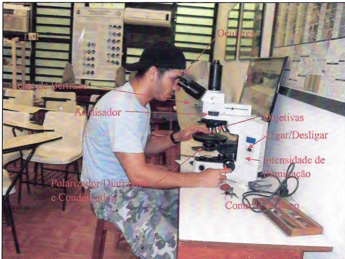
FIGURA 5.3 - Microscópio de polarização por luz transmitida, com seus principais elementos indicados.
