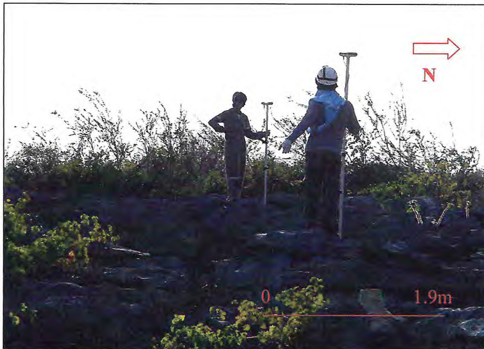
FIGURA 4.13 - Levantamento sistemático das juntas pelo método da linha, através da medida das distâncias entre fraturas sucessivas de um mesmo conjunto, ao longo de uma linha de dez metros de comprimento, perpendicular à direção de cada uma das quatro famílias identificadas, J_1 , J_2 , J_3 e J_4 , medidas feitas com GPS Geodésico. Coordenadas: 647764/9384812- WGS-84-UTM-24S.
