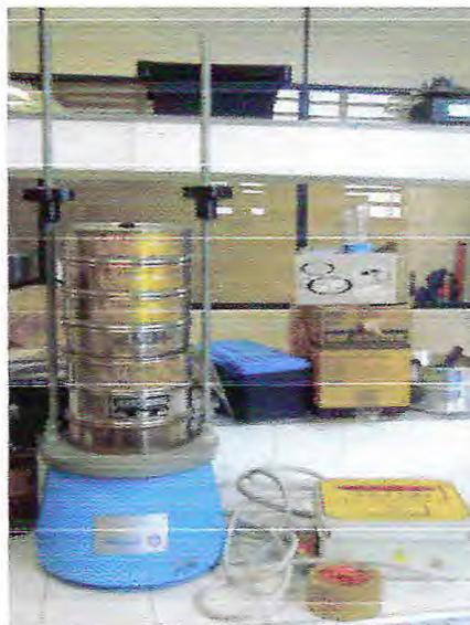
Figura 4 – Sequência de peneiras no equipamento Ro-tap para material grosseiro.
