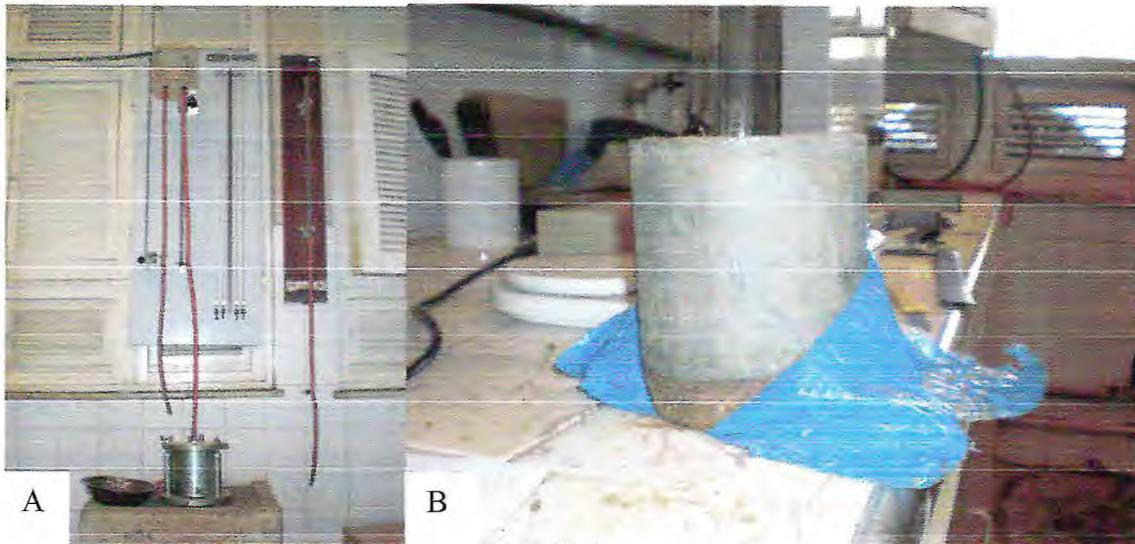
Figura 6 – (A) Permeômetro (permeabilidade variável) e (B) amostra utilizada no ensaio.
