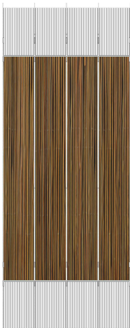
FECHAMENTO PARA PROTEÇÃO SOLAR FORMADO POR CANIÇOS DE BAMBU SOBRE CAIXILHO DE AÇO
