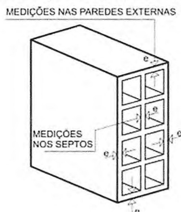
Figura 16: Posições Esquemáticas Para as Medições da Espessura das Paredes Externas e Septos.
