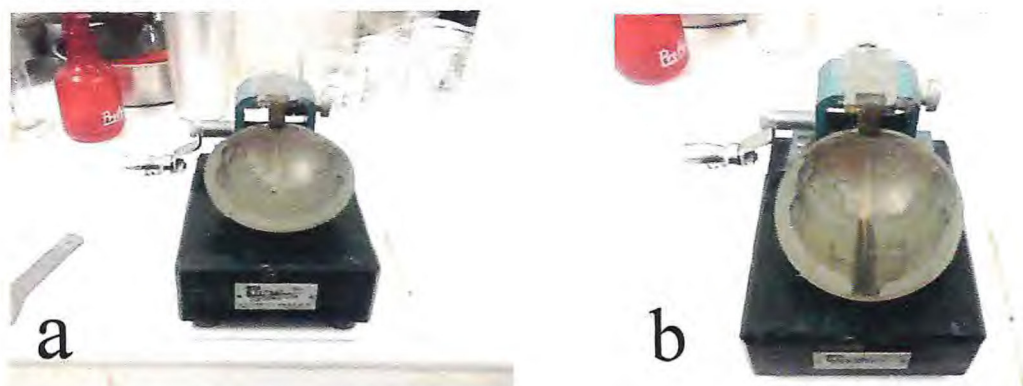
Figura 8 – Aparelho de Casa Grande a) Massa da amostra moldada a concha do aparelho e b) Massa da amostra moldada e dividida ao meio.
