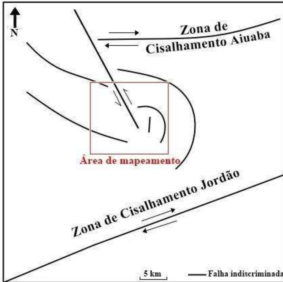
Figura 26 – Arcabouço estrutural da região de Pio IX, área é caracterizada por megadobra de arrasto formada pelo movimento das zonas de cisalhamento Aiuaba e Jordão e pela presença de falha transcorrente sinistral de rejeito quilométrico e falha indiferenciada menor.
