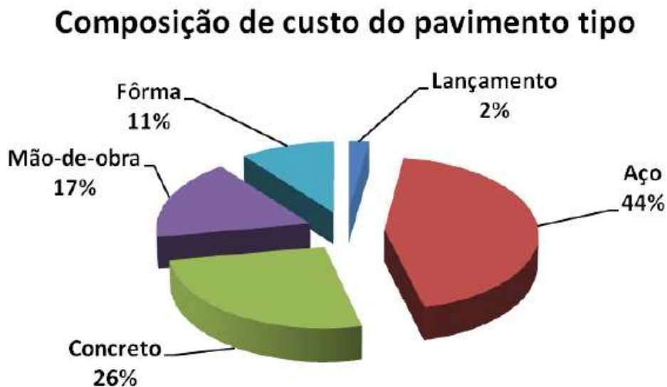
Figura 7 - Distribuição de custo de um pavimento tipo
