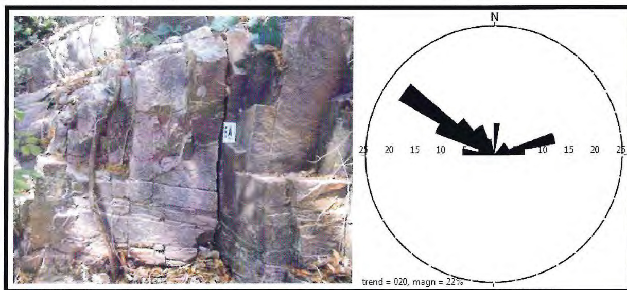
Figura 5.11 – Metarriolitos intensamente fraturados, apresentando os dois padrões de fraturamentos [P107: 292276m E/9466111m N]. Diagrama de roseta enfatizando a direção preferencial NW.
