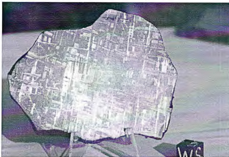
Figura 3.24 – Octaedrito Gibeon polido mostrando o padrão de Widmanstätten (fonte: http://s2.hubimg.com/u/214421_f520.jpg )
