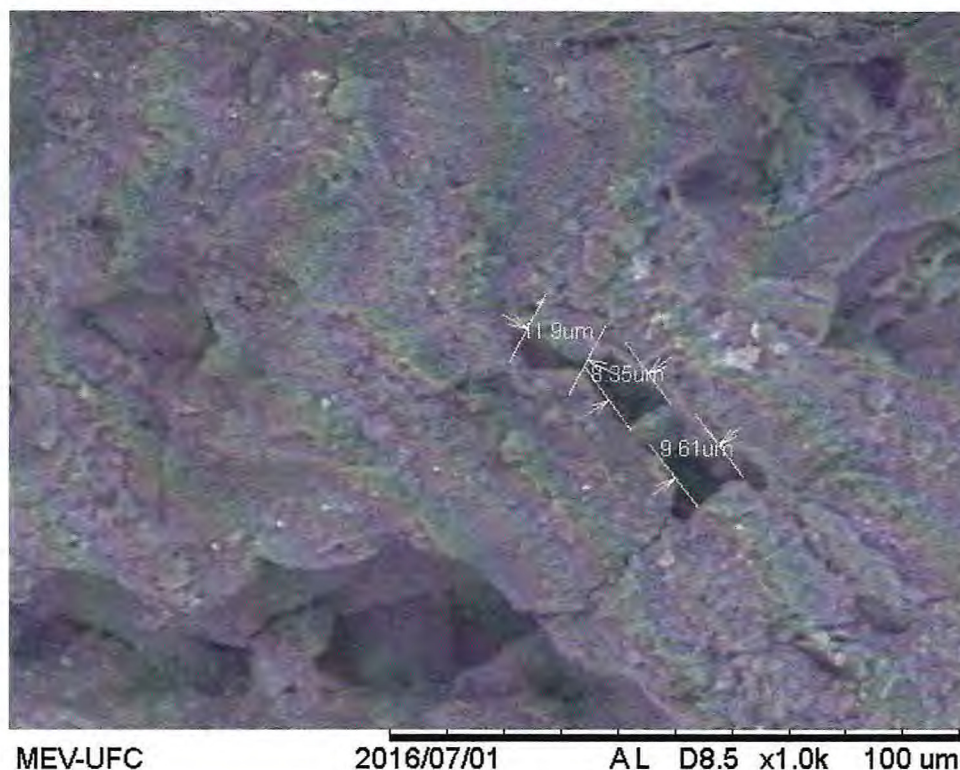
Figura 33 – Aspecto e medidas de poros na amostra de folhelho GDF-25.
