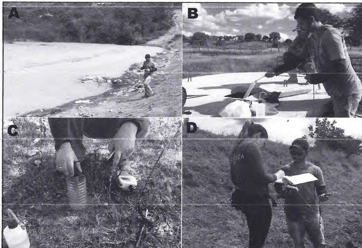
Figura 5 - (A) Lagoa dentro do lixão referente ao ponto 1 com maior teor de contaminação; (B) coleta de amostra em cacimba; (C) Medição dos parâmetros temperatura, pH e condutividade elétrica com sonda multiparamétrica; (D) recolhendo dados do ponto 2. (Fonte: Autores Santos & Lage, 2016).
