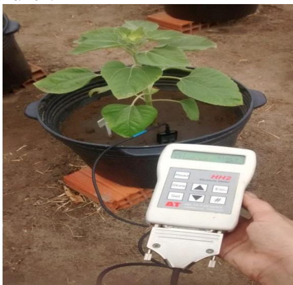
Figura 7 – Medição da condutividade elétrica do solo através de um sensor, Fortaleza, CE. 2016/2017
