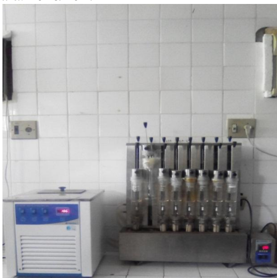
Figura 12 - Aparelho extrator de gordura TE - 044 da TECNAL® para extração de óleo. Fortaleza, Ceará. 2016/2017
