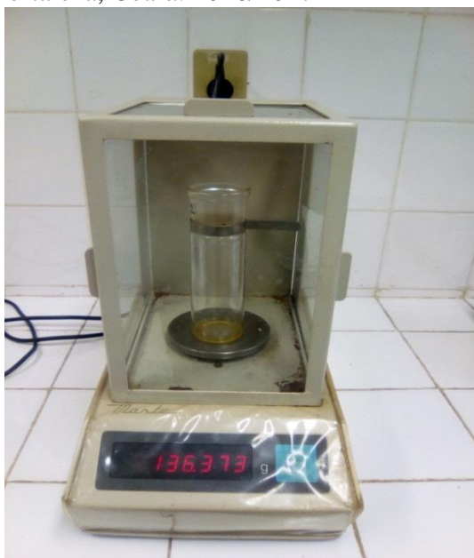
Figura 13 – Pesagem do tubo coletor para obtenção da massa de óleo extraída. Fortaleza, Ceará. 2016/2017
