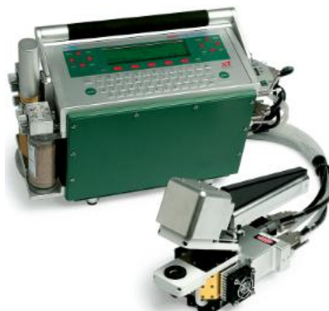
Figura 10 – Analisador de gás infravermelho portátil (IRGA) modelo Li – 6400XT
