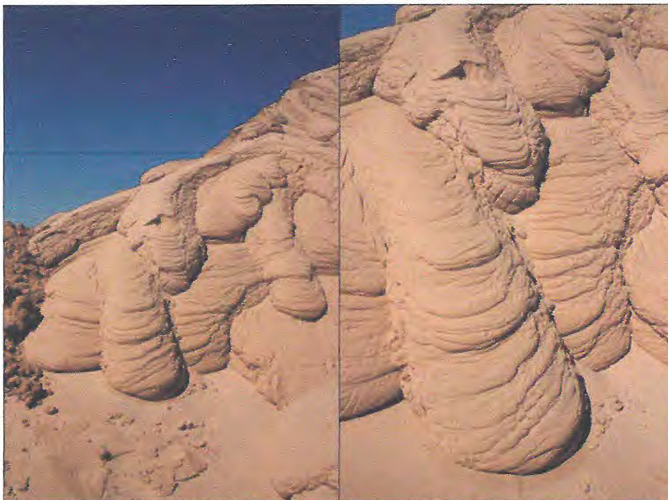
Figura 10: Modelo-escala de fluxos de detritos parcialmente amalgamados em lobos. Material: rejeito de mineração de areia da Formação Pirambóia no Estado de São Paulo. Fraturas subverticais são vistas no detalhe à direita.
