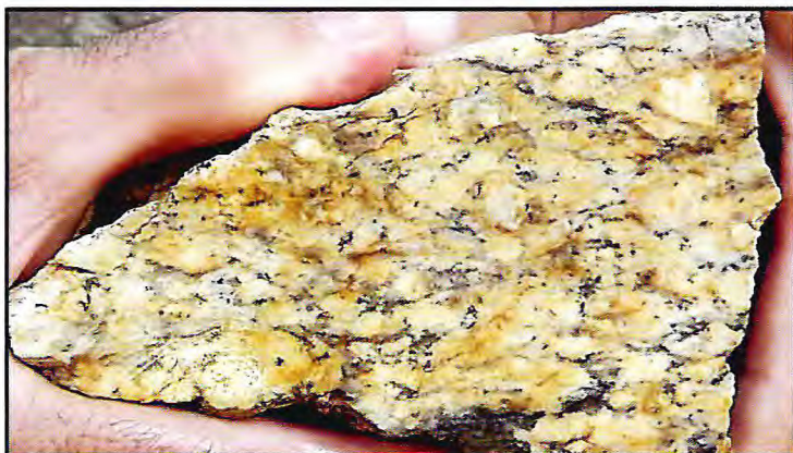
Figura 29. Amostra de mão (face serrada para elaboração de seção delgada) relativa a leucogranitóide deformado (biotita augengnaisse) encaixado na Formação Barrigas. Fotografo: A. F. Cavalcante.
