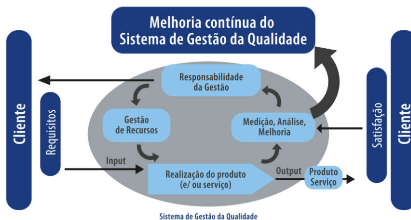
Figura 4 - Modelo de melhoria contínua do sistema de gestão de qualidade, conforme a norma ISO 9001:2008.
