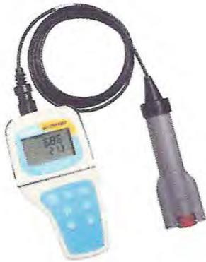
Figura 5 - Sonda medidora de pH, temperatura e condutividade elétrica (Marca OAKTON WATERPROOF). Fonte: (Autores, 2017).
