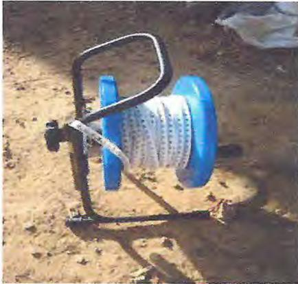
Figura 4 - Medidor de nível d'água com eletro-sonoro (modelo HSNA – 30). Fonte: (Autores, 2017).
