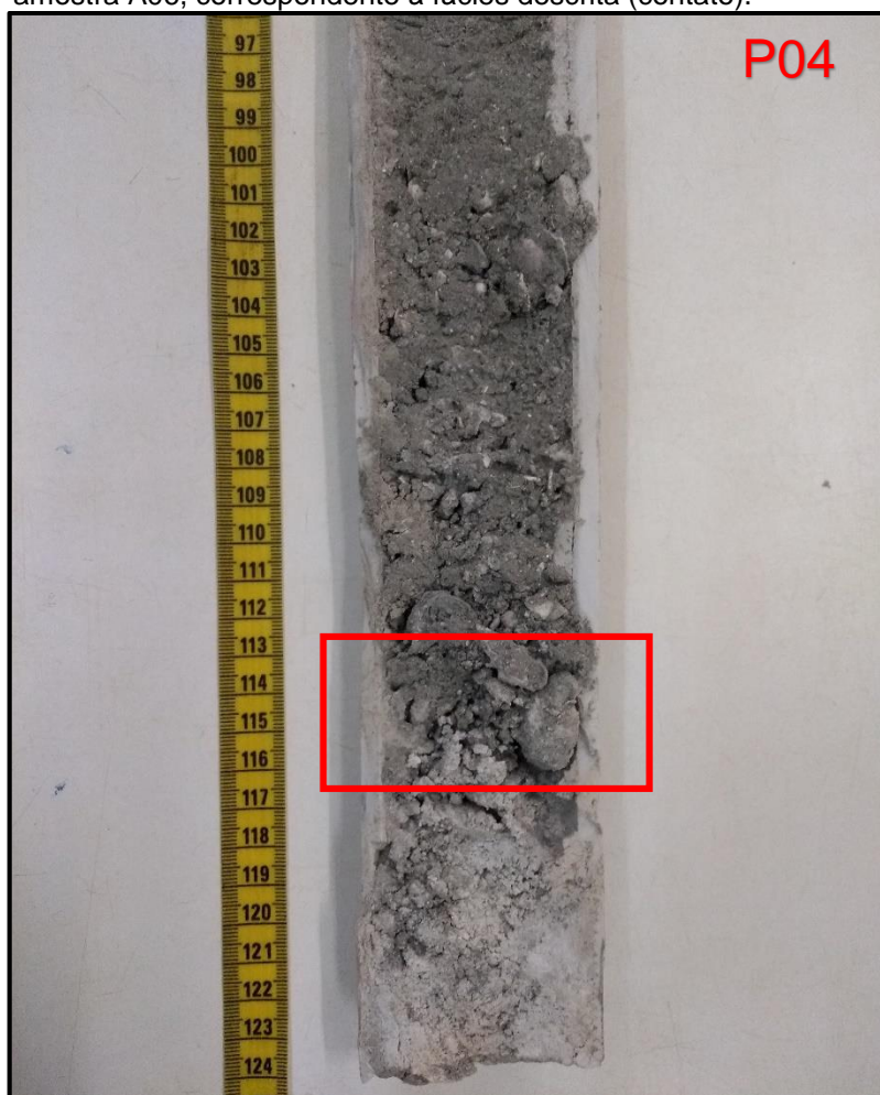
Figura 25: Base do testemunho P04, sendo evidenciado na figura a amostra A06, correspondente à fácies descrita (contato).
