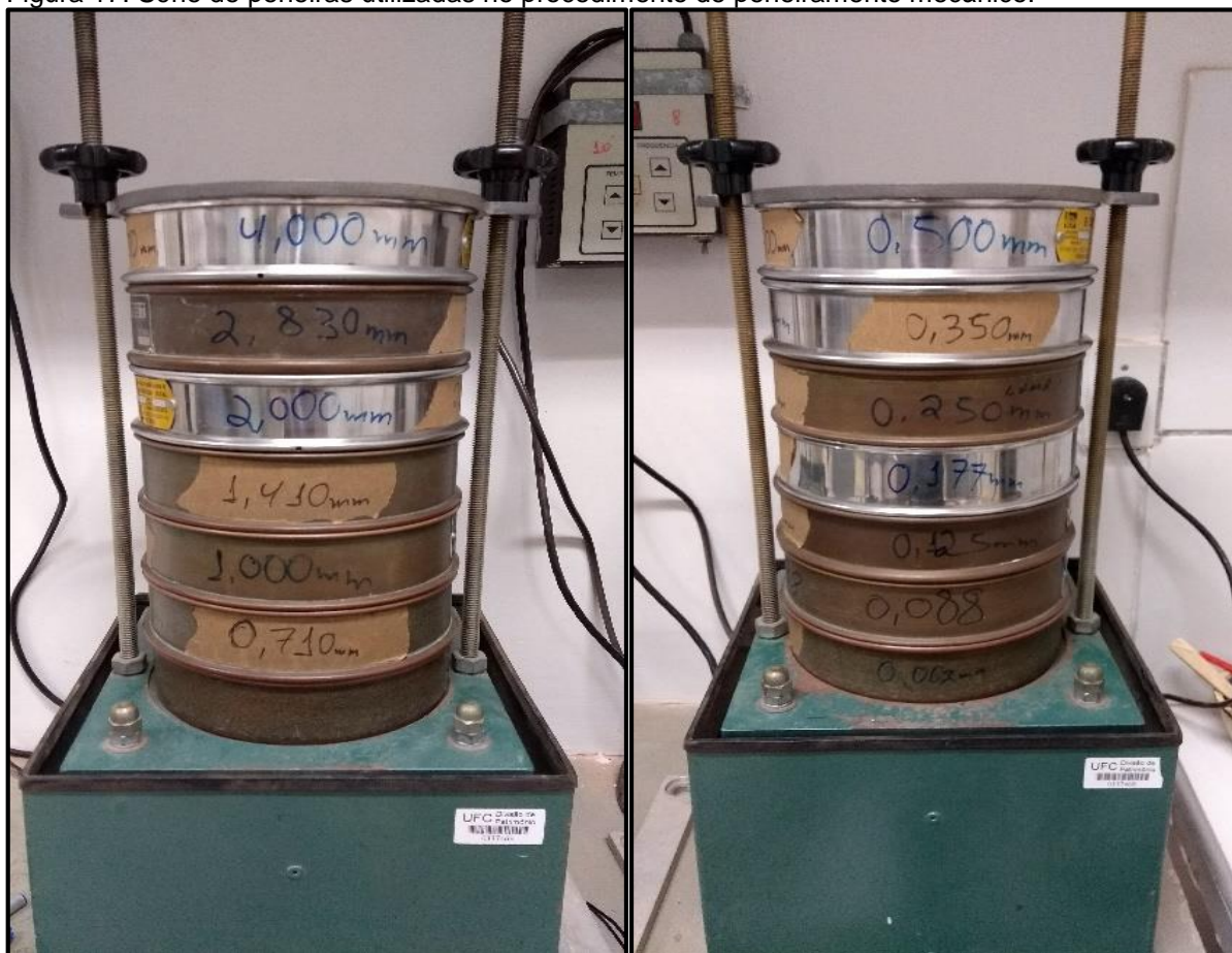
Figura 17: Série de peneiras utilizadas no procedimento de peneiramento mecânico.
