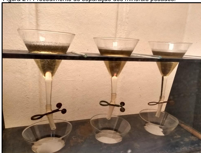
Figura 21: Procedimento de separação dos minerais pesados.
