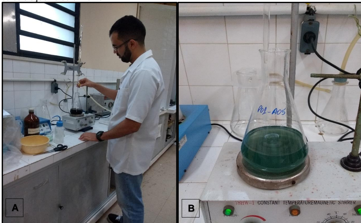
Figura 20: A: Determinação da matéria orgânica por titulação. B: Ponto de viragem com o aparecimento da coloração verde brilhante.
