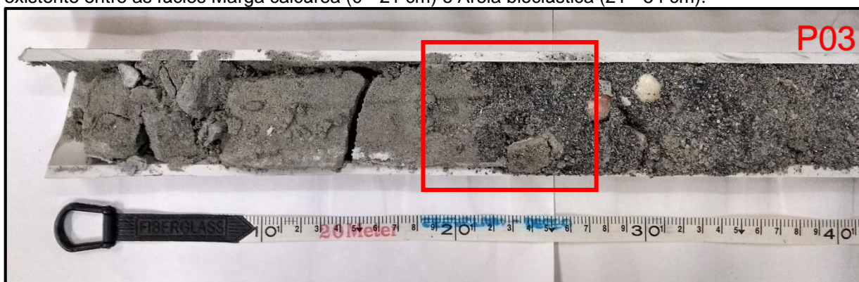
Figura 28: Amostra A02 do testemunho P03, indicada na figura, que corresponde ao contato brusco existente entre as fácies Marga calcárea (0 - 21 cm) e Areia bioclástica (21 - 54 cm).
