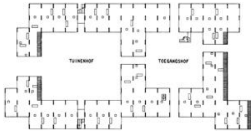
Fig.30: Planta baixa do que pode ser denominado como “ support ”, ou estrutura, na qual estão determinadas as circulações, malha estrutural e shafts.
