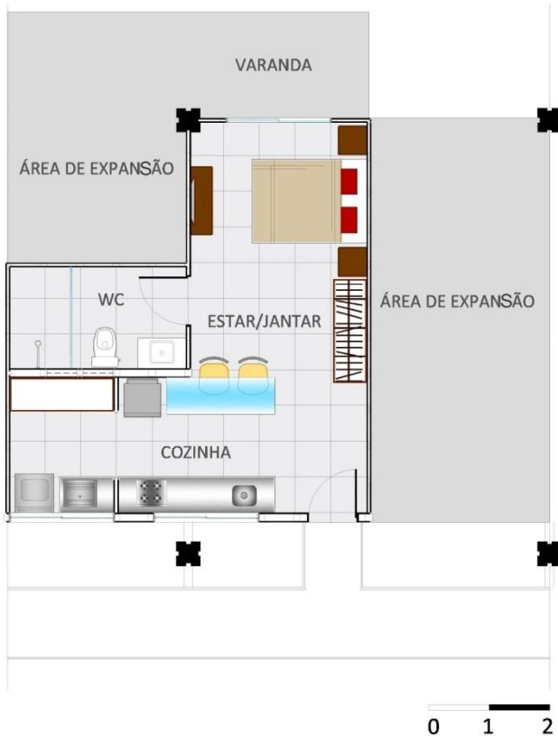
Fig. 63: Layout tipo 2, sem expansão. Este layout é uma combinação de área inicial menor com praticamente as mesmas possibilidades de expansão. Inicialmente é implantado o núcleo de áreas molhadas, necessidade básica de cada morador. O dormitório é integrado a sala, levando em consideração que a unidade será habitada por no máximo duas pessoas, o layout não deve trazer problemas de privacidade interna. Esta disposição tem área inicial de 38 m 2 , sendo expansível até 71 m 2 . Fonte: Elaborada pelo autor.
