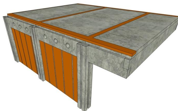
Fig. 58: Vigas de bordo e lajes de concreto pré-moldado com rebaxos para concretagem de juntas in loco são posicionadas. São também fixados montantes de argamassa armada que farão o espaçamento dos painéis das divisórias. Nessa figura está demonstrada também a passagem da tubulação elétrica. Fonte: Elaborada pelo autor.
