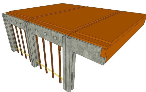
Fig. 58: Vigas de bordo e lajes de concreto pré-moldado com rebaxos para concretagem de juntas in loco são posicionadas. São também fixados montantes de argamassa armada que farão o espaçamento dos painéis das divisórias. Nessa figura está demonstrada também a passagem da tubulação elétrica. Fonte: Elaborada pelo autor.
