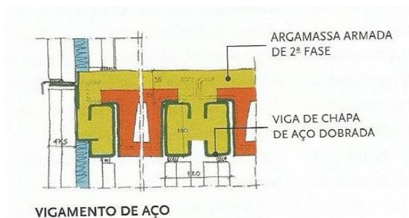
Fig.26: Croquis de João Filgueiras Lima. À esquerda seção da laje, formada em parte por pré-moldados e em parte por concretagem in loco . À direita, seção das peças de vedação entremeadas com isolamento de isopor nas paredes externas, ou de lã de rocha nas paredes internas. Em baixo, detalhe das vigas comum e de bordo, que consistem em perfis metálicos, preenchidos com argamassa.
