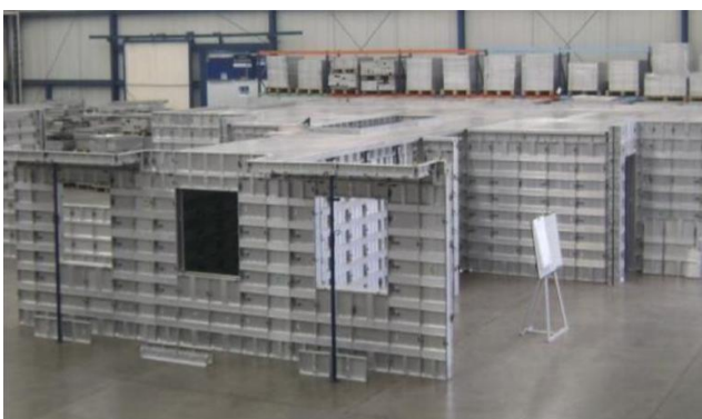
Fig.15: Imagens de um sistema construtivo para produção seriada de habitações. O sistema consiste de uma fôrma de alumínio, que dura até 1000 ciclos de concretagem, produzindo unidades idênticas de paredes estruturais e lajes de concreto armado. O resultado é uma obra enxuta, eficiente e rápida, a grande desvantagem é a total inflexibilidade tipológica, pois o sistema não permite nenhuma variação construtiva.
