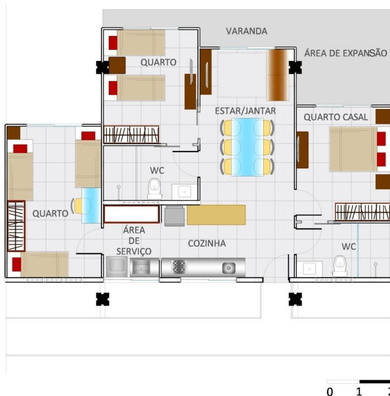
Fig. 62: Layout tipo 1, segunda expansão. Este layout é a maior tipologia inserida no estudo, com uma área de aproximadamente 91 m 2 , otimizada para 7 pessoas. Fonte: Elaborada pelo autor.
