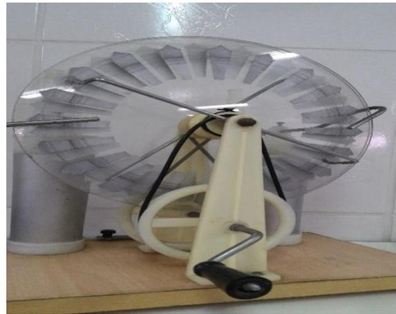
Figura 8.9. Gerador Eletrostático.
