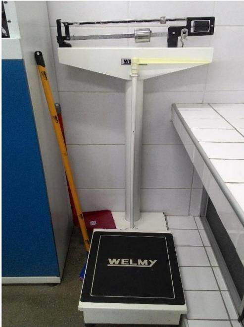
Figura 8.6. Balança Mecânica Antropométrica.
