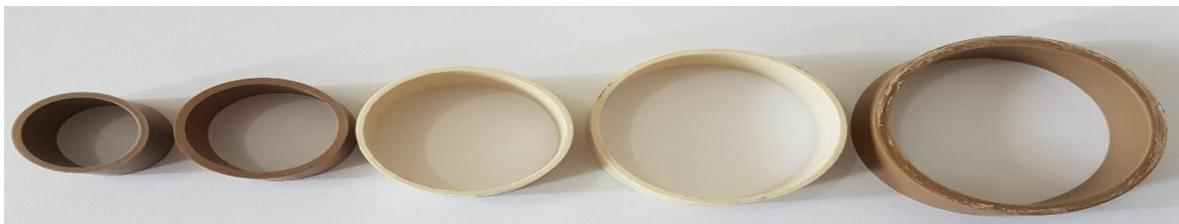
2. Meça (COM A RÉGUA R 1) o diâmetro externo e o comprimento da circunferência correspondente de cada “anel”. Anote três medidas independentes. Uma medida para cada membro da equipe.
