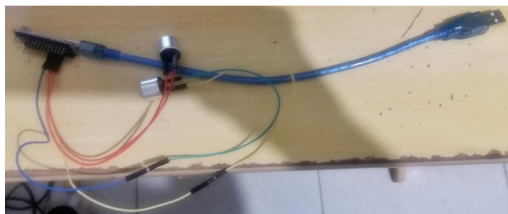
Figura 23. Minilevitador acústico de baixo custo.
