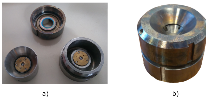
Figura 2.7 – Célula de pressão Diamond Anvil Cell (MDAC), usada para variar a pressão no experimento 2 realizado no cristal de DL-isoleucina, desmontada em partes em a) e montada em b).
