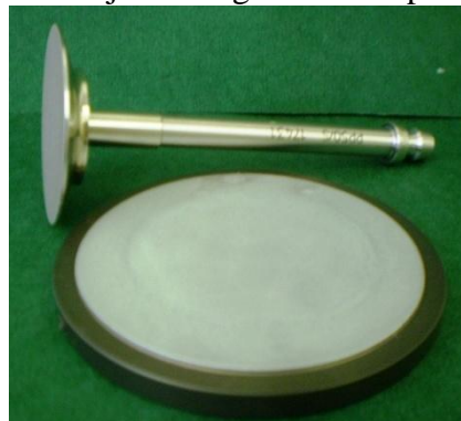
Figura 5.2 Conjunto de geometria e placa rugosa.
