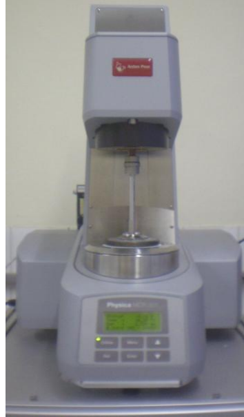
Figura 5.2 Conjunto de geometria e placa rugosa.
