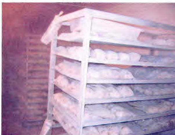
**Figura 19-** Acondicionamento de caudas de lagosta no túnel de congelamento, na INTERFRIOS – Intercâmbio de Frios S/A, em Fortaleza, Ceará.
