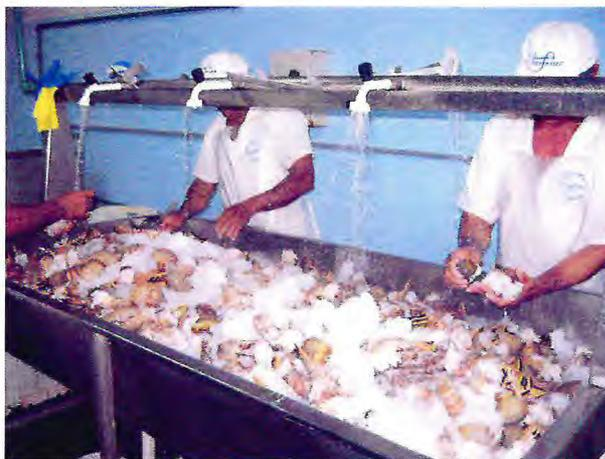
**Figura 2-** Mesa de aço inox dotada de chuveiros verticais, utilizados no recebimento das caudas de lagosta, na INTERFRIOS – Intercâmbio de Frios S/A, em Fortaleza, Ceará.
