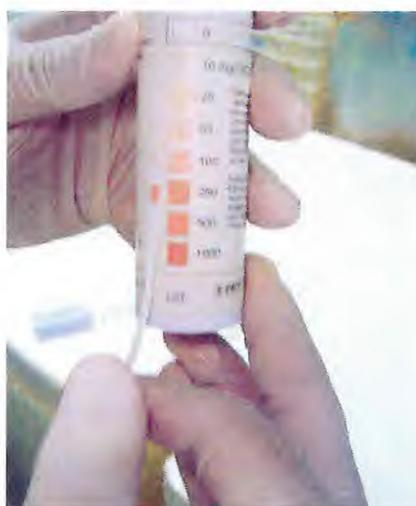
**Figura 10-** Semi-teste quantitativo (fita “MERCK”), para a determinação do teor residual de  $\text{SO}_2$  nas caudas de lagosta, na recepção da INTERFRIOS – Intercâmbio de Frios S/A, em Fortaleza, Ceará.
