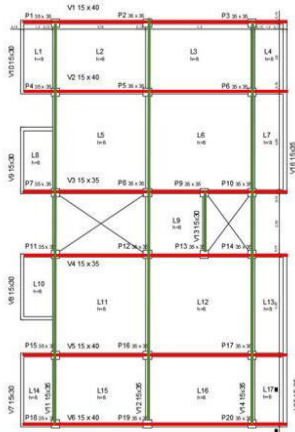
Figura 31: Exemplos de estruturas de contravento.
