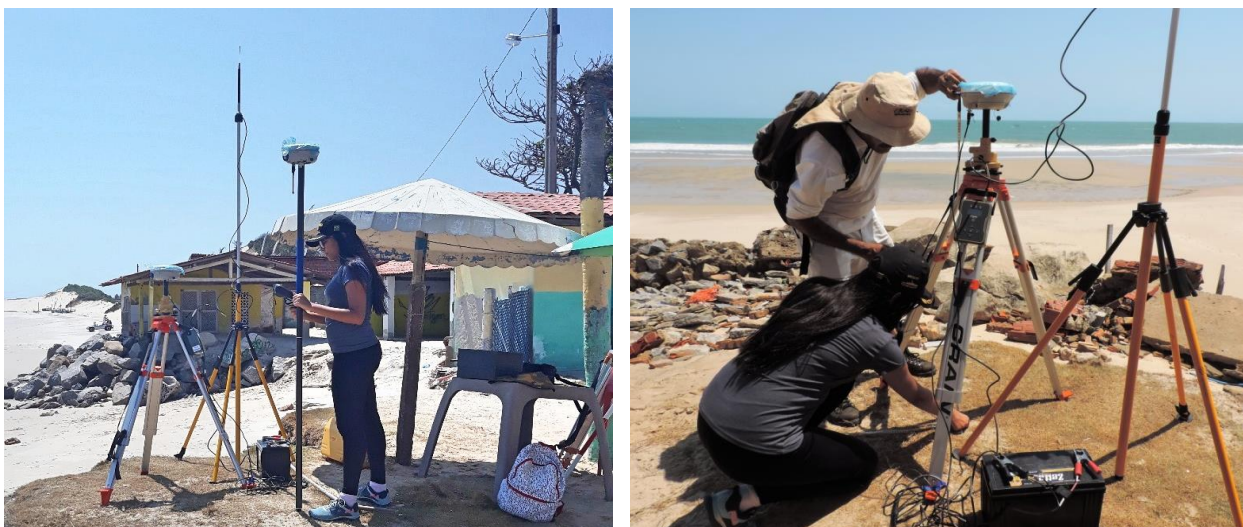
Figura 6: Instalação da base do RTK.
