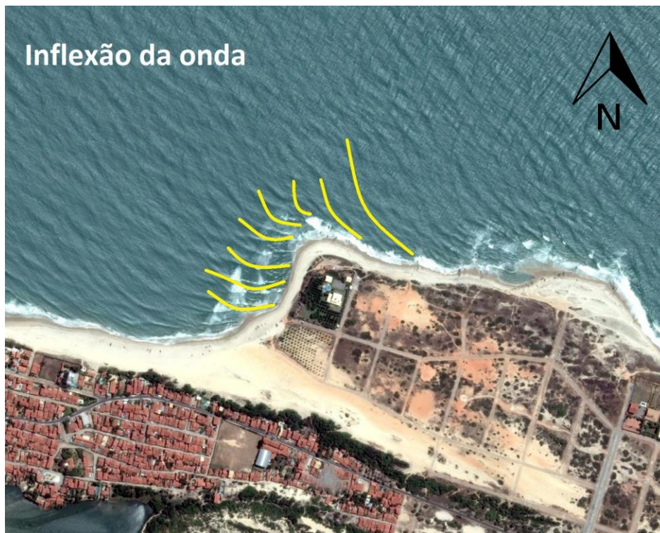
Figura 4: Inflexão da onda ao atingir o promontório ocorrendo a difração da onda.
