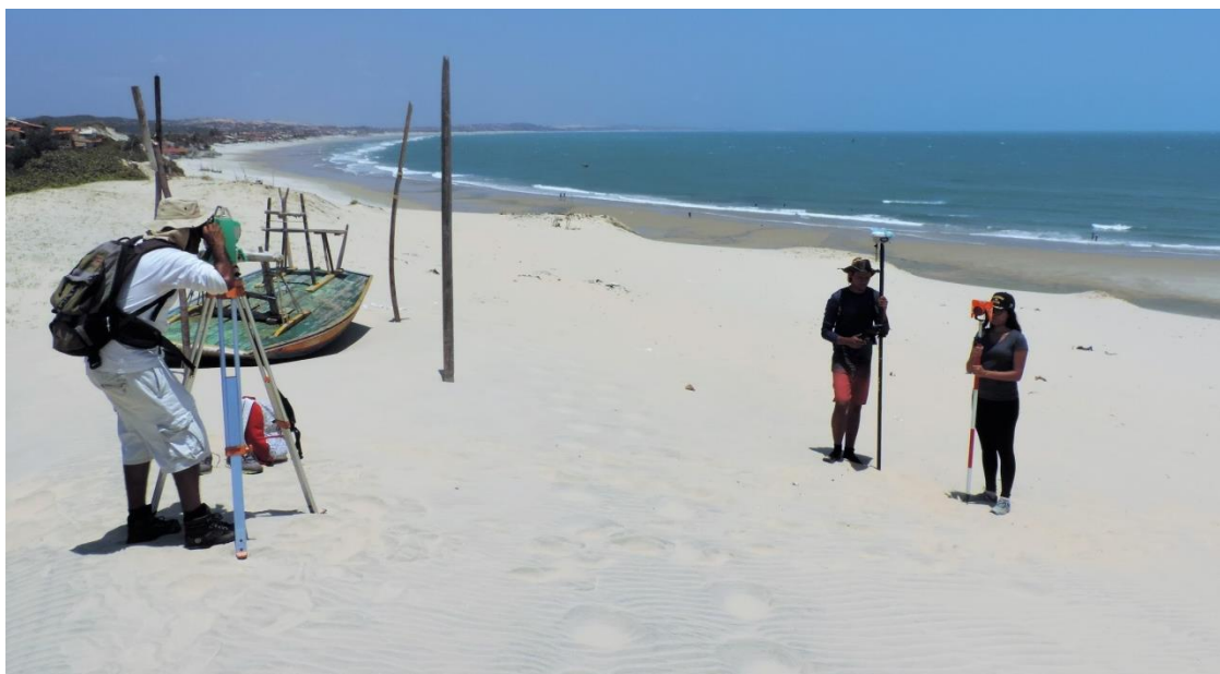
Figura 7: Aquisição de dados topográficos a partir de Estação Total.
