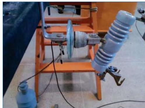
Fig. 5 – Ensaio em chave fusível com duplo isolamento
