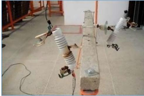
Fig. 6 – Chaves fusíveis em que foram realizados os ensaios
