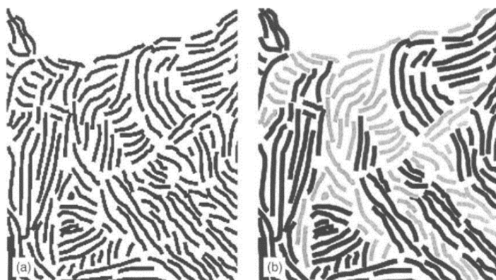
Figura 7 – Porosidade de um material antes (esquerda) e depois (direita) de um processo de ativação
