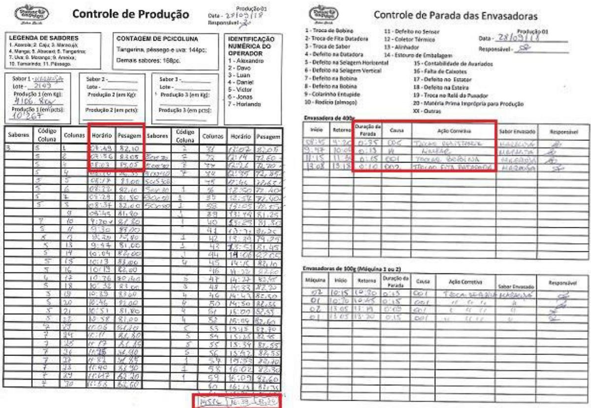
Figura 55 - Controles de produção mostrando início e fim do expediente produtivo, além das paradas de máquina do dia.
