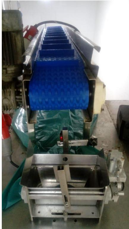
Figura 53 - Ponto de caída dos sachês frente à esteira e sensor identificador dos sachês que caem por tempo.
