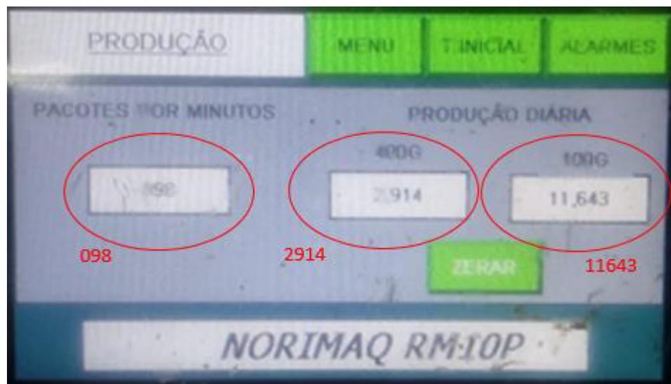
Figura 54 - Tela mostrando a velocidade de sachês sendo contabilizados por minuto, a produção agregada total de sachês de 100g, assim como também o enfardado geral de 400g.
