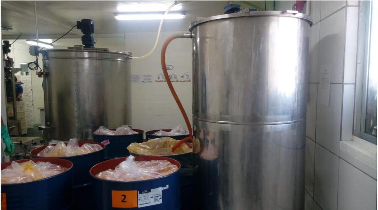
Figura 27 - Tanque de diluição a direita e tanque de homogeneização a esquerda.
