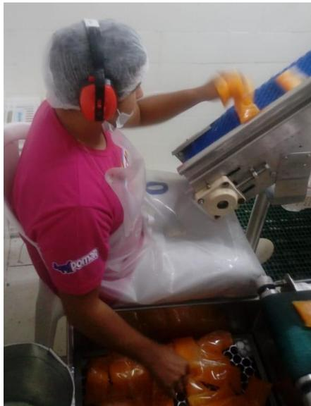
Figura 58 - Operador auxiliando na movimentação de sachês de uma esteira para outra.
