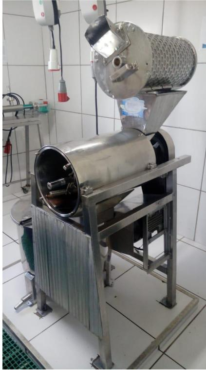
Figura 25 - Despolpadeira com a estrutura interna retirada.
