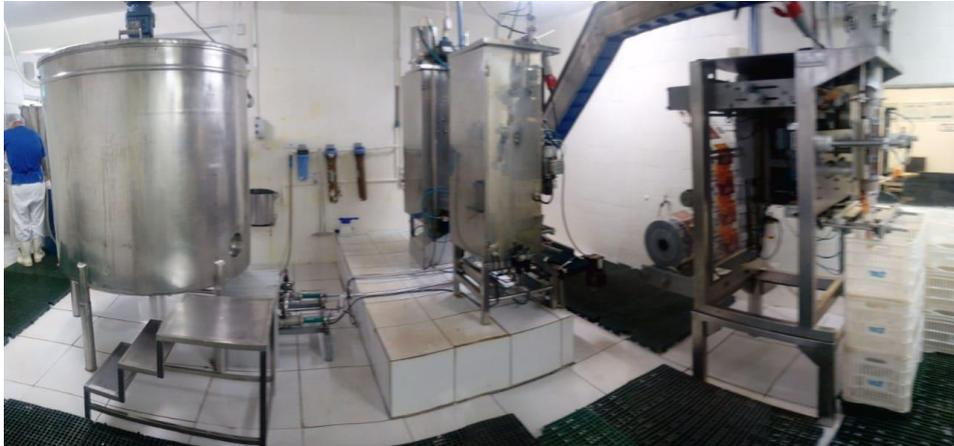
Figura 28 - Tanque de homogeneização a esquerda, 2 envasadoras a direita, interligadas com uma esteira e uma enfardadeira.
