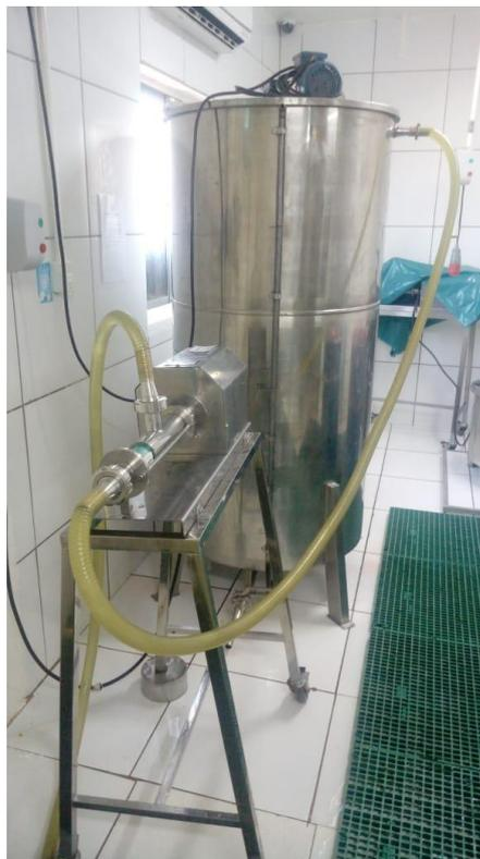
Figura 57 - Tanque de homogeneização intermediário.
