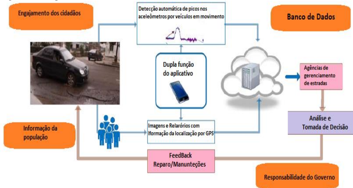
Figura 9 – Esquema de funcionamento do Roadlab
