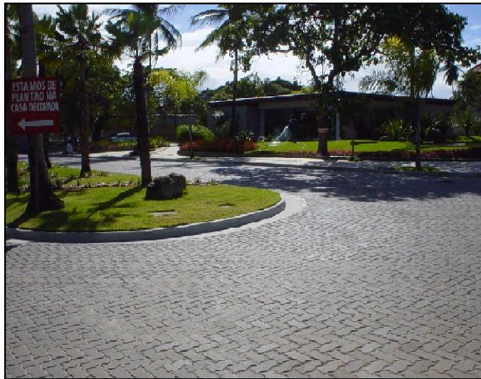
**Foto 6: Via constituída por piso intertravado de concreto**
