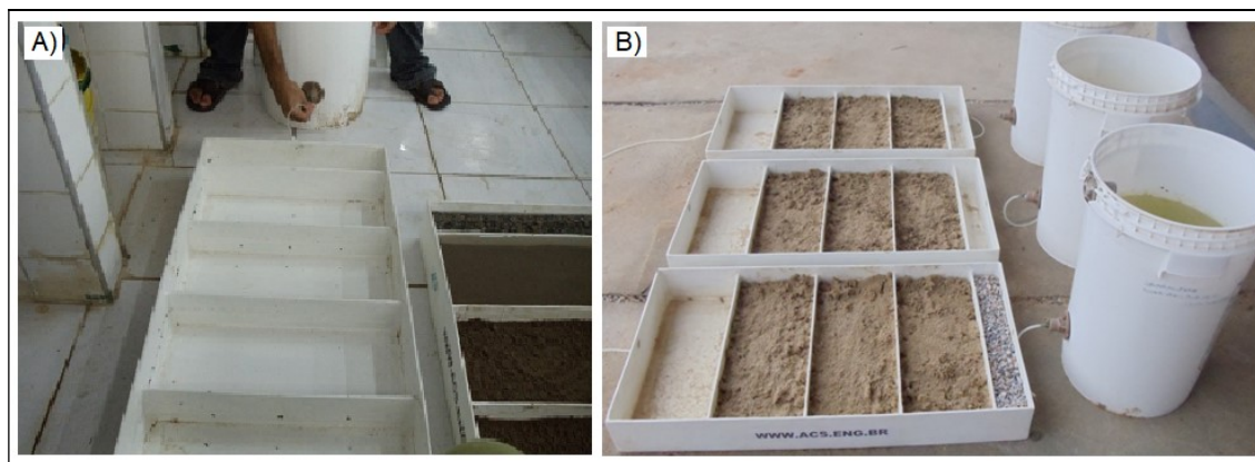
Figura 5 – Sistemas de fibra de vidro: compartimentos sem brita e areia (A), primeiro compartimento preenchido com brita e outros três com areia (B).
