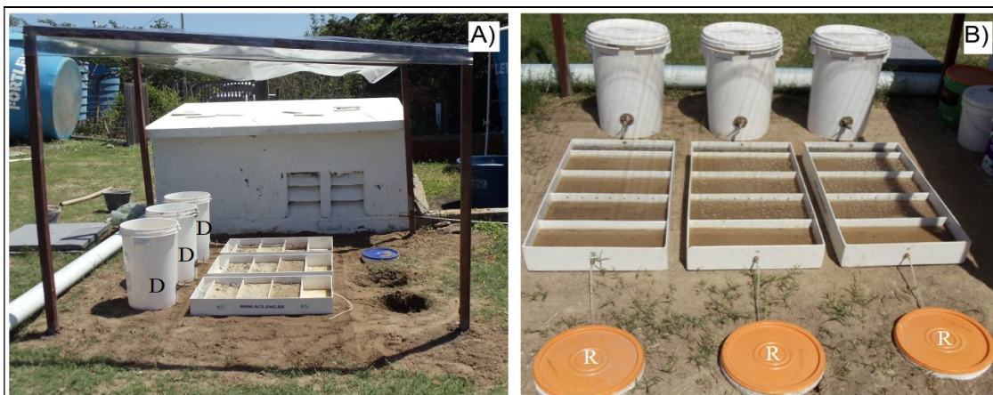
Figura 8 – Montagem do experimento: (A) recipientes, decantadores – D, de água/efluente para encaminhamento aos sistemas, e (B) os recipientes, receptores – R, com tampas alaranjadas, enterrados após os sistemas para o recebimento da água/efluente por gravidade.
