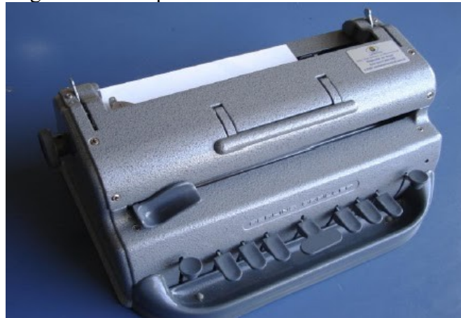
Figura 20 – Máquina mecânica de escrita Braille
