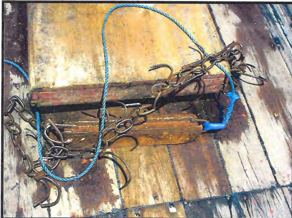
Figura 7 – “Centopéia” utilizada no recolhimento dos espinhéis de potes.
