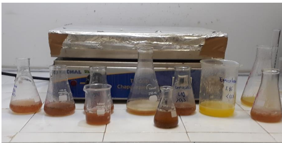
Figura 5 - Amostras durante o processo de degradação da matéria orgânica com sulfato de ferro II e peróxido de hidrogênio.
