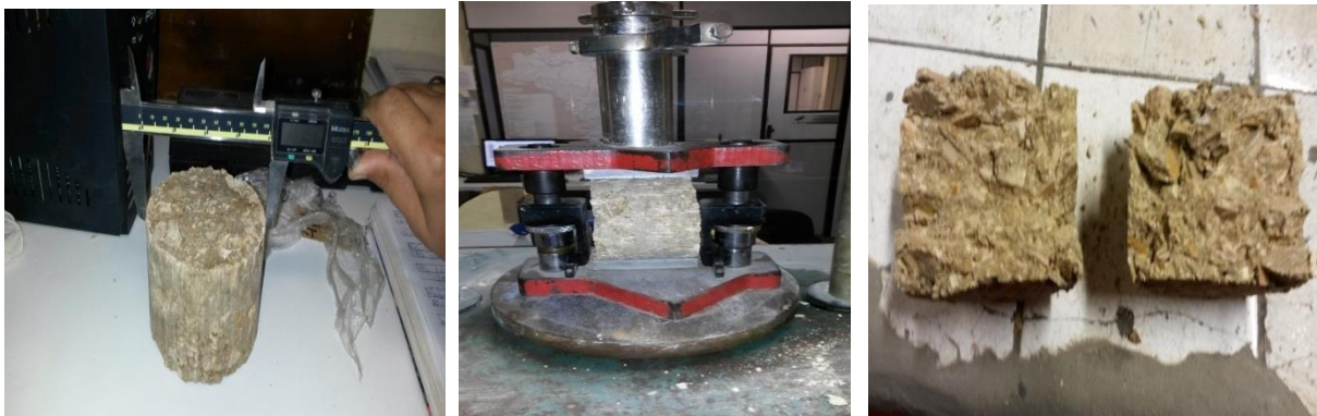
Figura 36 - Ilustração da realização do ensaio de RT (medição e rompimento) para o RPC puro+5,5% cimento
