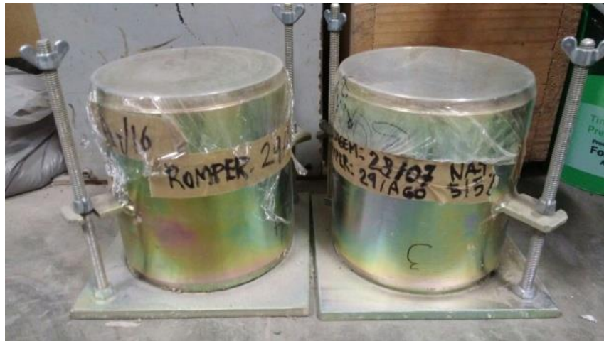
Figura 19 - CBRs em processo de cura do RPC puro+5,5% de cimento.
