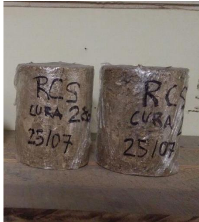
Figura 20 - Corpos de prova do RPC puro+5,5% de cimento em processo de cura.
