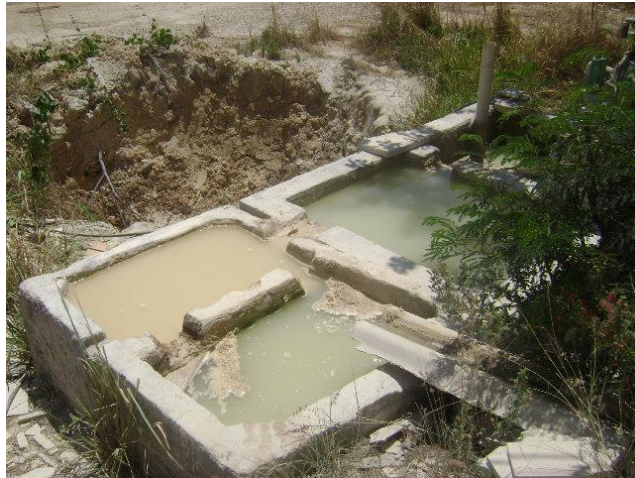
Figura 13 - Efluente formado da serragem de placas.
