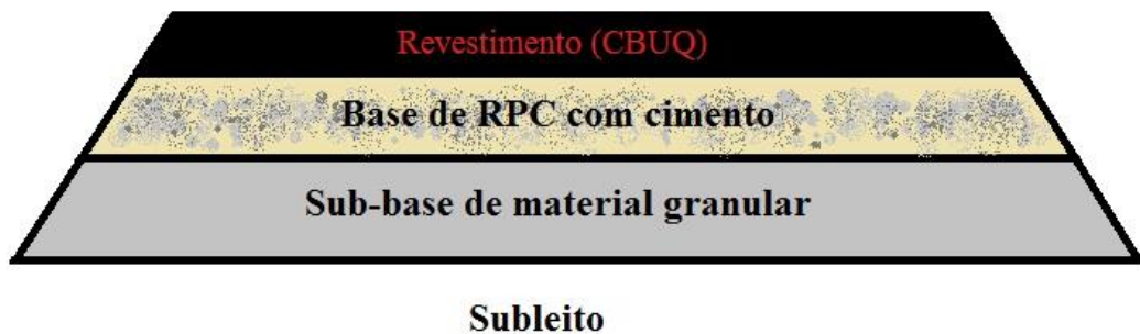
Figura 38 - Ilustração da estrutura com RPC com cimento para N=7 \times 10^6 .
