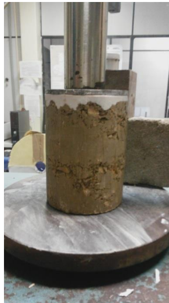
Figura 21 - Corpo de prova do RPC puro+5,5% de cimento submetido ao ensaio de RCS.
