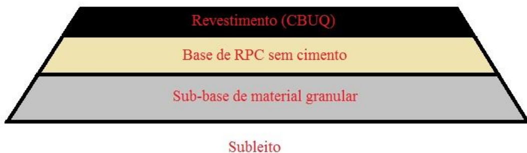
Figura 37 - Desenho esquemático da estrutura com RPC sem cimento para N=2 \times 10^6 .
