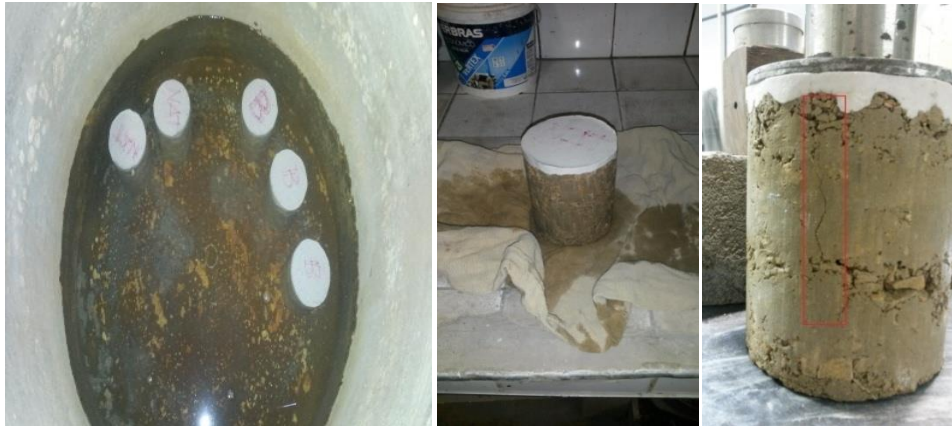
Figura 34 - Procedimento de imersão, secagem superficial e rompimento dos CPs.
