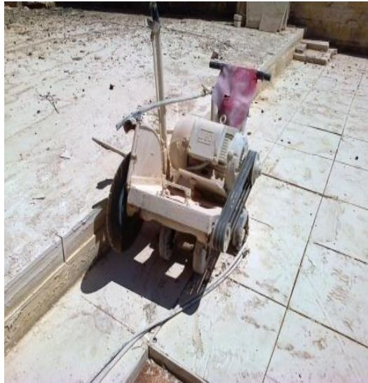
Figura 9 - Equipamento de corte de placas da Pedra Cariri.
