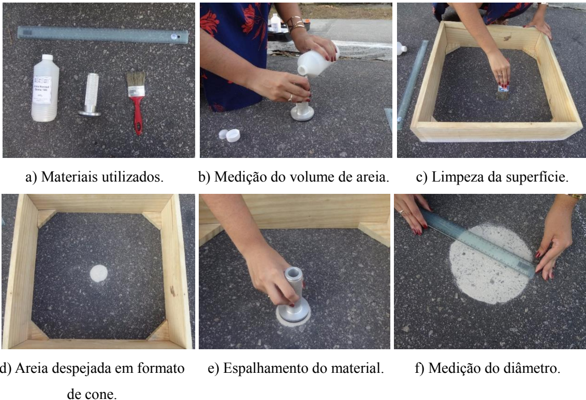
Figura 11 – Procedimentos do ensaio de Mancha de Areia.
