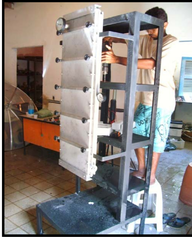
Figura 24– Montagem do fotoreator híbrido na estrutura suporte, utilizado nos experimentos
