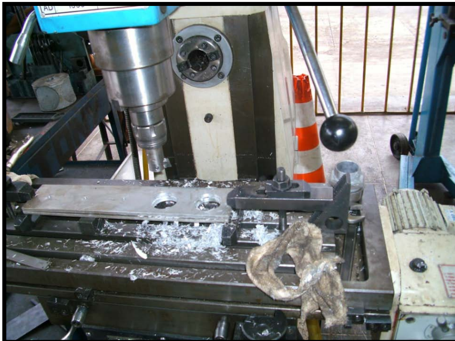
Figura 16– Usinagem das placas de alumínio.
