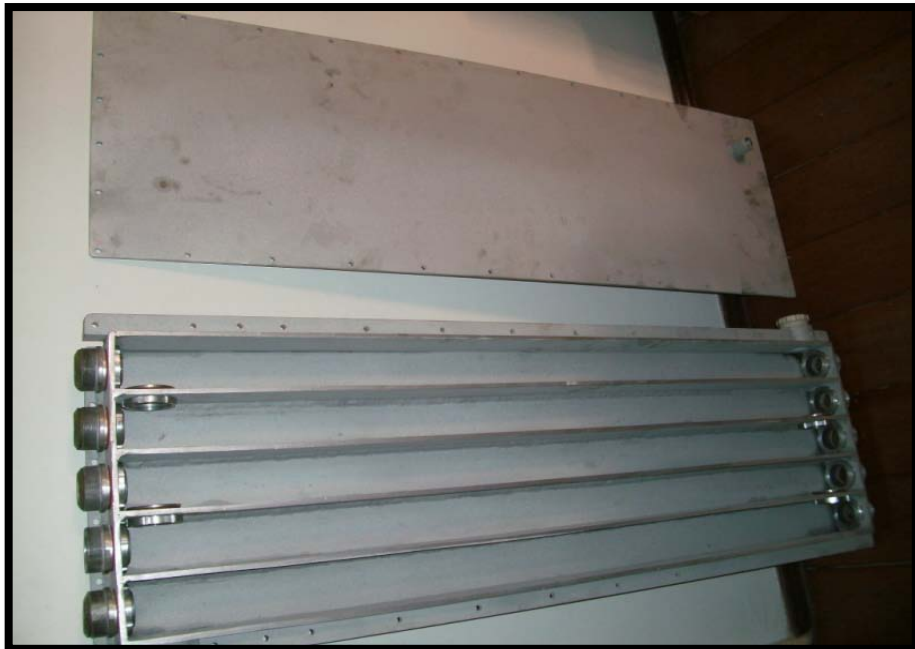
Figura 18 – Construção do Fotoreator híbrido concluída.
