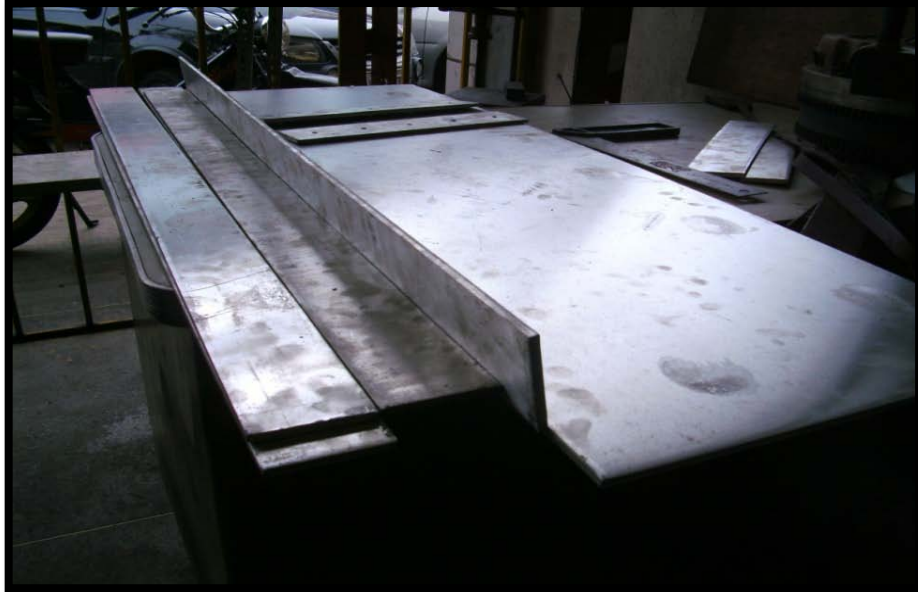
Figura 15 – Placas de alumínio utilizadas na construção do Fotoreator.
