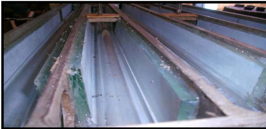
Figura 20- Ambiente interno do fotoreator: lâminas de vidro com \text{TiO}_2 imobilizado e luvas de quartzo.
