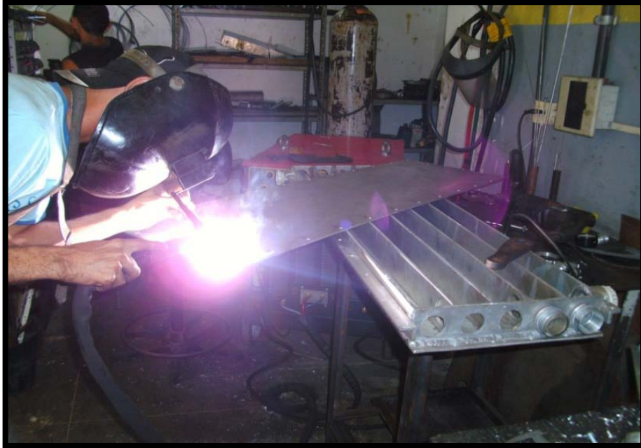
Figura 17 – Soldagem das placas de alumínio.
