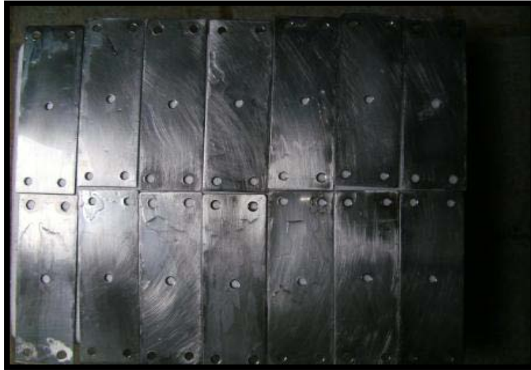
Figura 12– Placas de aço inox, utilizadas como eletrodos.
