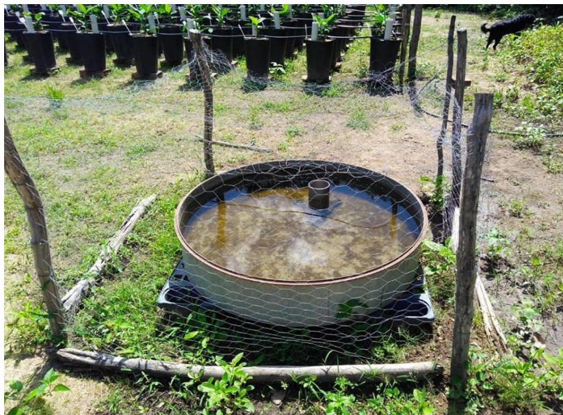
Figura 3 - Tanque classe “A” instalado próxima a área experimental
