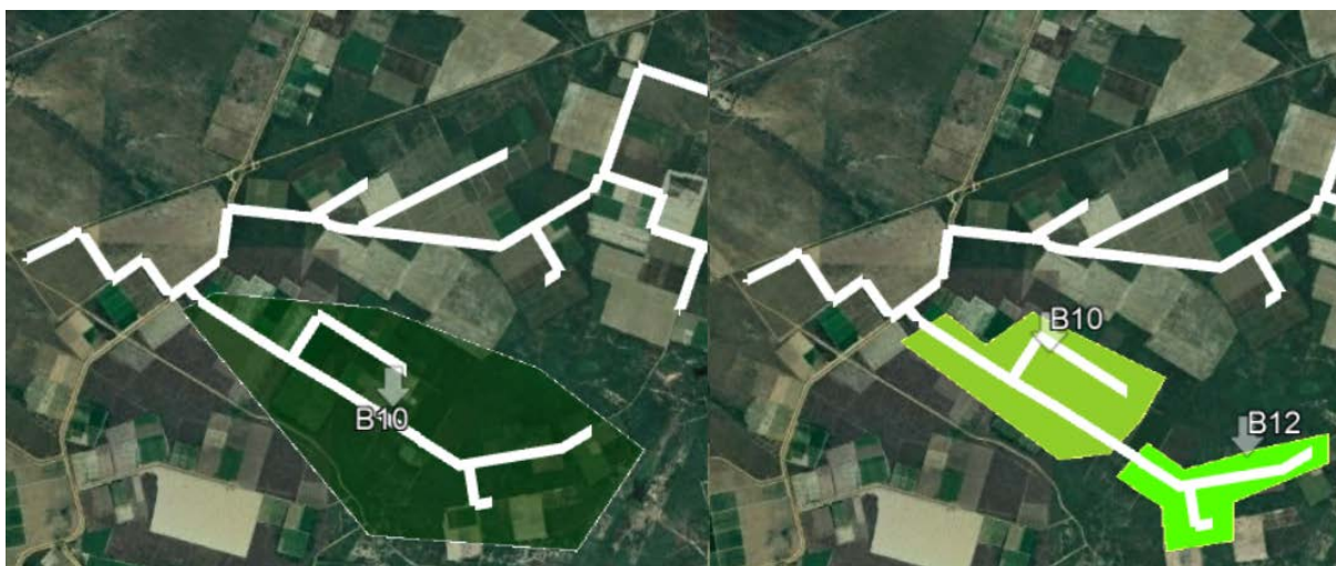
Figura 36 – Instalação de um equipamento seccionador no bloco B10.
