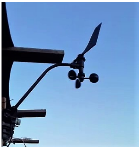
Figura 8 – Anemômetro da Davis ® , modelo S-WCF-M003.
